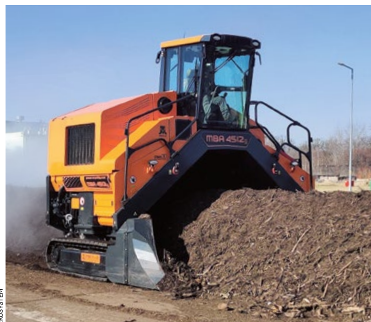
Odpady na kompost są rozdrabniane i regularnie przerzucane
